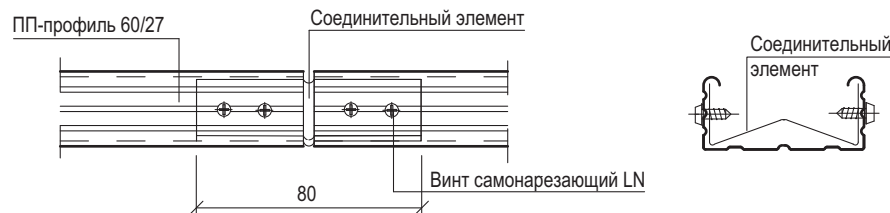
Соединение стоек ПП 60/27 по высоте
