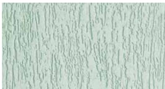
Акриловая штукатурка **Ceresit CT 63**, зерно 3,0 мм, инструмент нанесения: стальная терка, инструмент фактурирования: пластмассовая терка.
