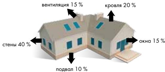
Как видно из рисунка, наружные стены играют значительную роль в потерях тепла. Поэтому устройство тепловой изоляции наружных стен, особенно с внешней их стороны, будет обеспечивать уменьшение интенсивности утечек тепла, ограничение и замедление изменения температуры в помещении, а также, что не менее важно, температуры конструктивных слоев самих стен.
