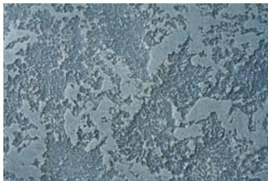
Минеральная штукатурка **Ceresit CT 36**, инструмент нанесения: стальная терка, инструмент фактурирования: венецианский шпатель, шпатель, кисть.
