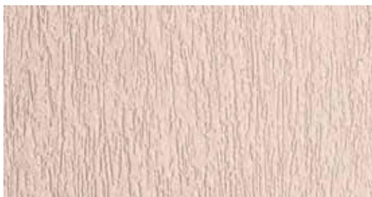
Минеральная штукатурка **Ceresit CT 35**, зерно 3,5 мм, инструмент нанесения: стальная терка, инструмент фактурирования: пластмассовая терка.
