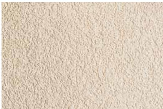
Минеральная штукатурка **Ceresit CT 137**, зерно 2,5 мм, инструмент нанесения: стальная терка, инструмент фактурирования: пластмассовая терка.
