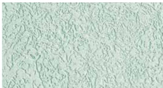
Минеральная штукатурка **Ceresit CT 35**, зерно 2,5 мм, инструмент нанесения: стальная терка, инструмент фактурирования: пластмассовая терка.
